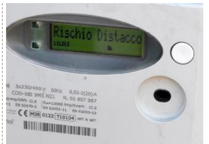
Contatore della luce segnala il superamento di potenza consentita
